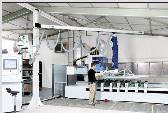
Movimentação de painéis de madeira.
