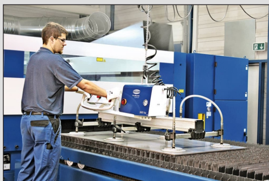
Movimentação de chapas metálicas.
