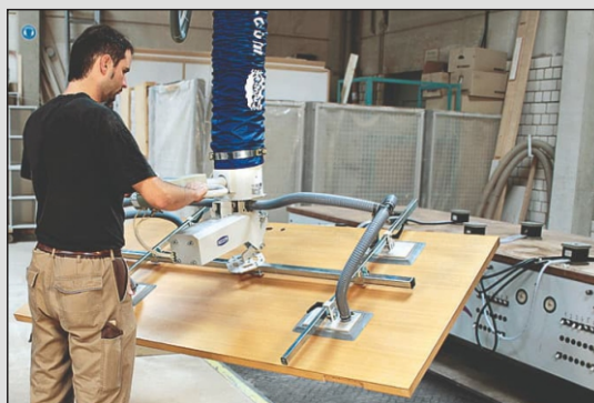
Movimentação de painéis de madeira.
